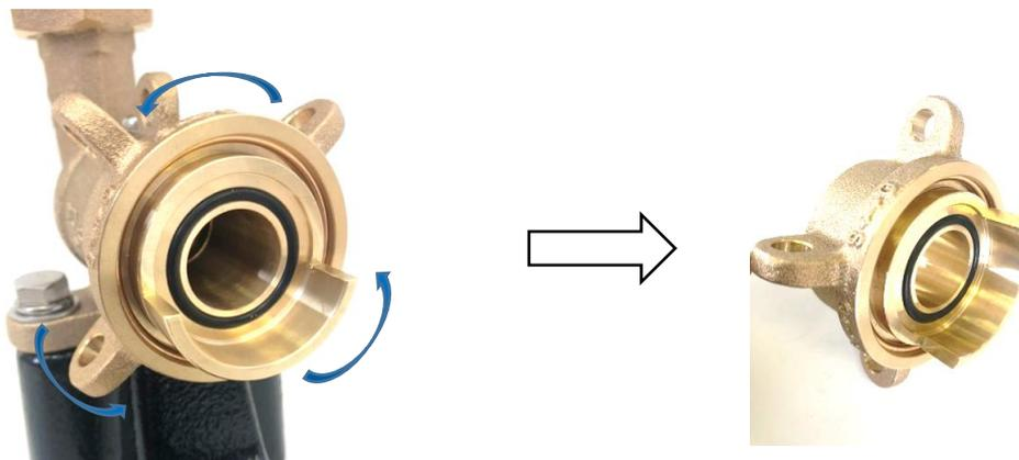
2. 伸縮管を手に取り、先端が尖っているものを用いてリングを外します。
